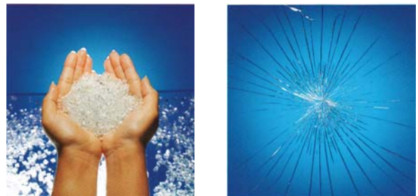
ภาพซ้ายลักษณะการแตกของกระจกนิรภัยเทมเปอร์ (Temper Safety Glass) ภาพขวาลักษณะการแตกของกระจกนิรภัย (Heat Strengthened Glass)
